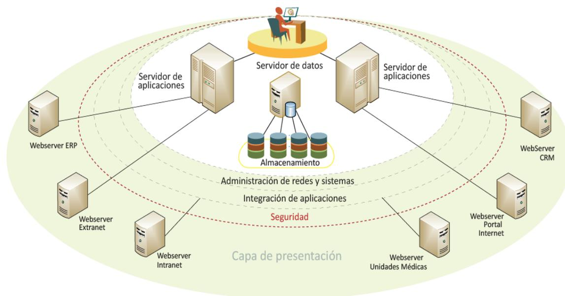
Como parte del detalle en capas de la arquitectura anterior, se puede observar la existencia de una capa de procesamiento, en donde se tendrán por un lado los servidores de aplicación y por otro los servidores de bases de datos.
